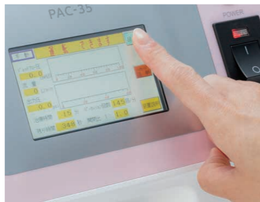
自動運転の設定は、本体のタッチパネルで行い、出力圧、パーカッション回数を制御します。
